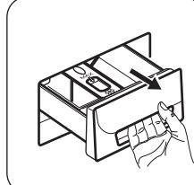
Потяните дозатор моющих средств на себя до упора. Положение **A** перегородки для моющих средств предназначено для порошкового моющего средства.
